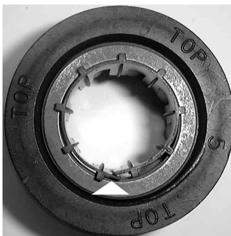
Abb. 9: Produktschwimmer mit nicht korrekt angebrachten Befestigungsclips
