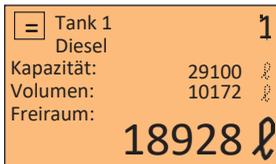
In der Betriebsart **manuell** erfolgt der Wechsel zwischen den einzelnen Tanks durch das wiederholte Bestätigen des Tasters.
